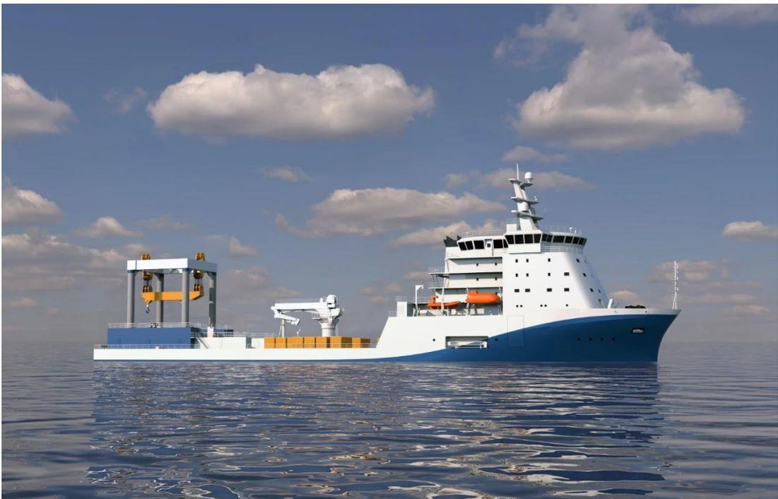
该科考船船总长 117.2 米，型宽 21 米，型深 9 米，设计吃水 5.4 米，设计排水量达到 7920 吨，最大作业排水量达到 10,100 吨，最大科考承载能力 600 余吨。由于耐波性好、抗涌浪强，具备 4 级海况收放作业能力，只要平均海面波高不超过 2 米，它就可以开展大部分科考工作。
